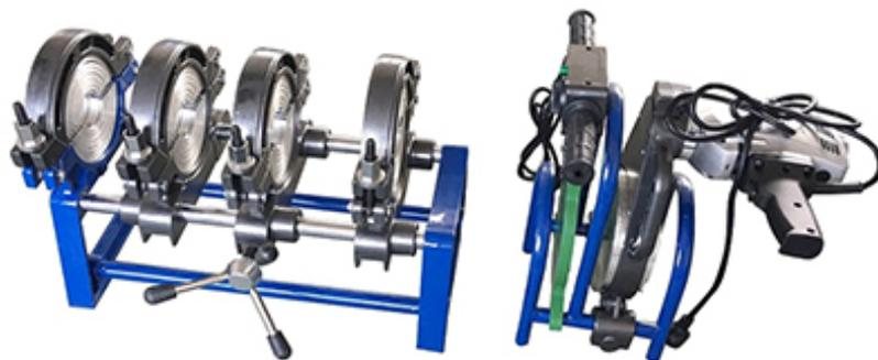
Механический стыковой сварочный аппарат SUD 40-160 M4 с четырьмя зажимными кольцами. Предназначен для монтажа труб из полиэтилена (высокого и низкого давления) и полипропилена.
